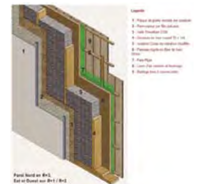
OSSATURE BOIS KERTO POUR LES FAÇADES NORD
