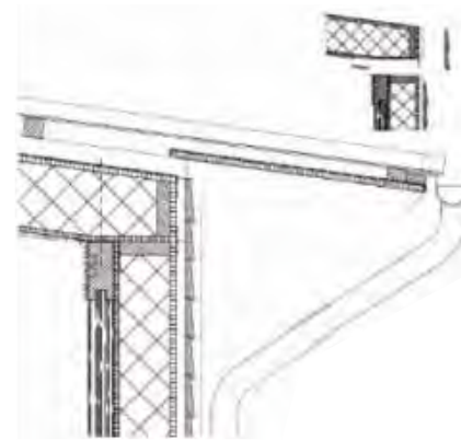
DÉTAIL DE LA JONCTION PLANCHER - TOITURE
