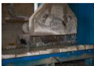
Coupe des pavés sur la plate-forme de Bonneuil-Sur-Marne
